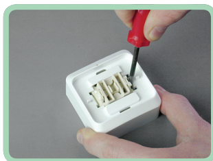
P116742 A csavarhúzó segítségével pattintsa szét a burkolatrögzítő pontokat mindkét oldalon és ezután vegye le a burkolatot.
